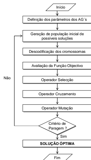
Figura 3. Fluxograma de um algoritmo genético básico
